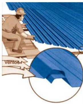
Figura 13 - Montagem das telhas no sentido oposto à direção do vento.
